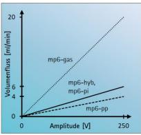
Die Amplitude definiert den Hub des Aktuators und damit die Verdrängung des zu fördernden Mediums pro Pumpzyklus.
