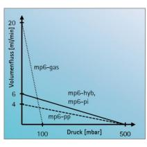
Die Förderraten der Pumpen sind linear abhängig vom Gegendruck.
