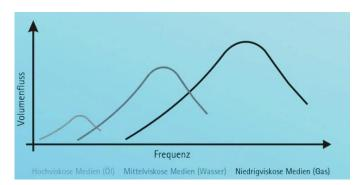
Die Lage und Ausprägung der Resonanzfrequenz und damit die maximale Flussrate ist medienabhängig (Viskosität).
