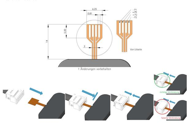
Beim Trennen der Pumpe muss der Molex Steckverbinder vorher geöffnet werden!
