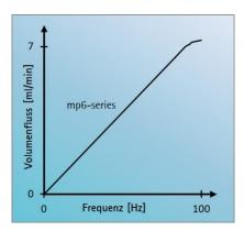
Die Frequenz bestimmt die Anzahl der Pumphübe in einer bestimmten Zeit. Mit steigender Frequenz erhöht sich die Förderrate in einem definierten Frequenzbereich linear. Das charakteristische Diagramm zeigt ein Maximum bei der Resonanzfrequenz.
