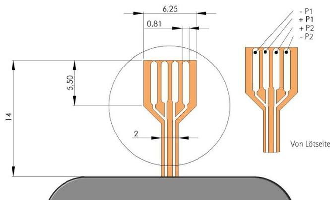
Wir empfehlen die Verwendung der 4-poligen FFC Steckverbinder der Firma Molex mit dem Rastermaß 1.25 mm. Der gerade Steckverbinder hat die Teilenummer 39 53 2045. Alternativ gibt es eine gewinkelte Version mit der Teilenummer 39 53 2044.
