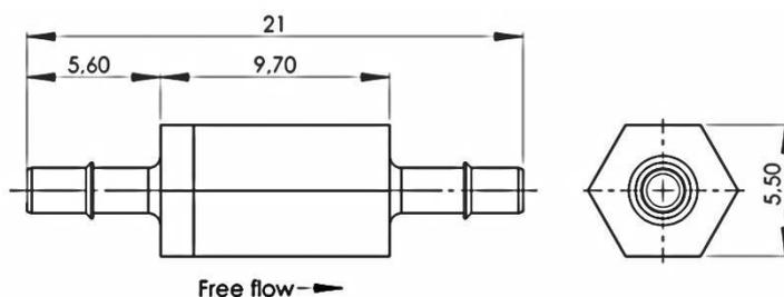
Die Ventile tragen eine Markierung für die Durchflussrichtung.
