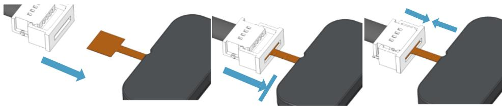
Beim Trennen der Pumpe, muss der Molex Steckverbinder vorher geöffnet werden!
