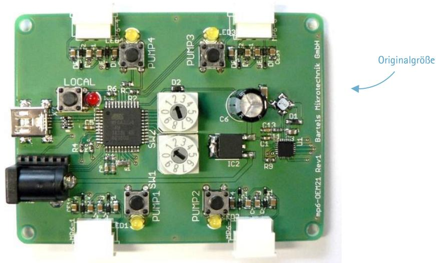
Dieses Board basiert nicht auf der **mp6-OEM** aufgrund der Signalerzeugung bei höheren Frequenzen. Ein DC Netzteil wird zur Spannungsversorgung benötigt. Der USB Anschluss ermöglicht es eine spezielle Software zur Steuerung von einzelnen oder allen Pumpen gleichzeitig zu nutzen. Diese Software ist mit dem Evaluationsboard verfügbar. Es ist allerdings auch möglich das Evaluationsboard direkt also ohne PC-Verbindung einzustellen und zu verwenden.
